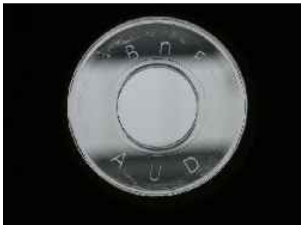
Photographie n°2 : disque compact non sérigraphié dans l'aire centrale, estampillage au laser
